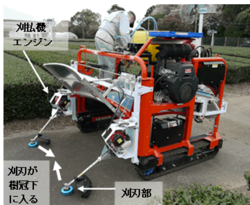
乗用型茶園管理機（茶園用病害虫クリーナー）に搭載した除草機
