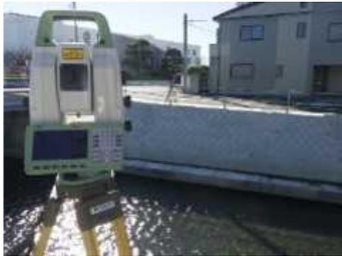
計測方法：既知点 or TS等光波方式による座標値計測
